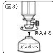
●ボンベへの取付けは、真直ぐにあてて少し回す様にして慎重に着脱してください。「つめかえ君」の中心にあるノズルにキズが付くとガス漏れの原因となります。
